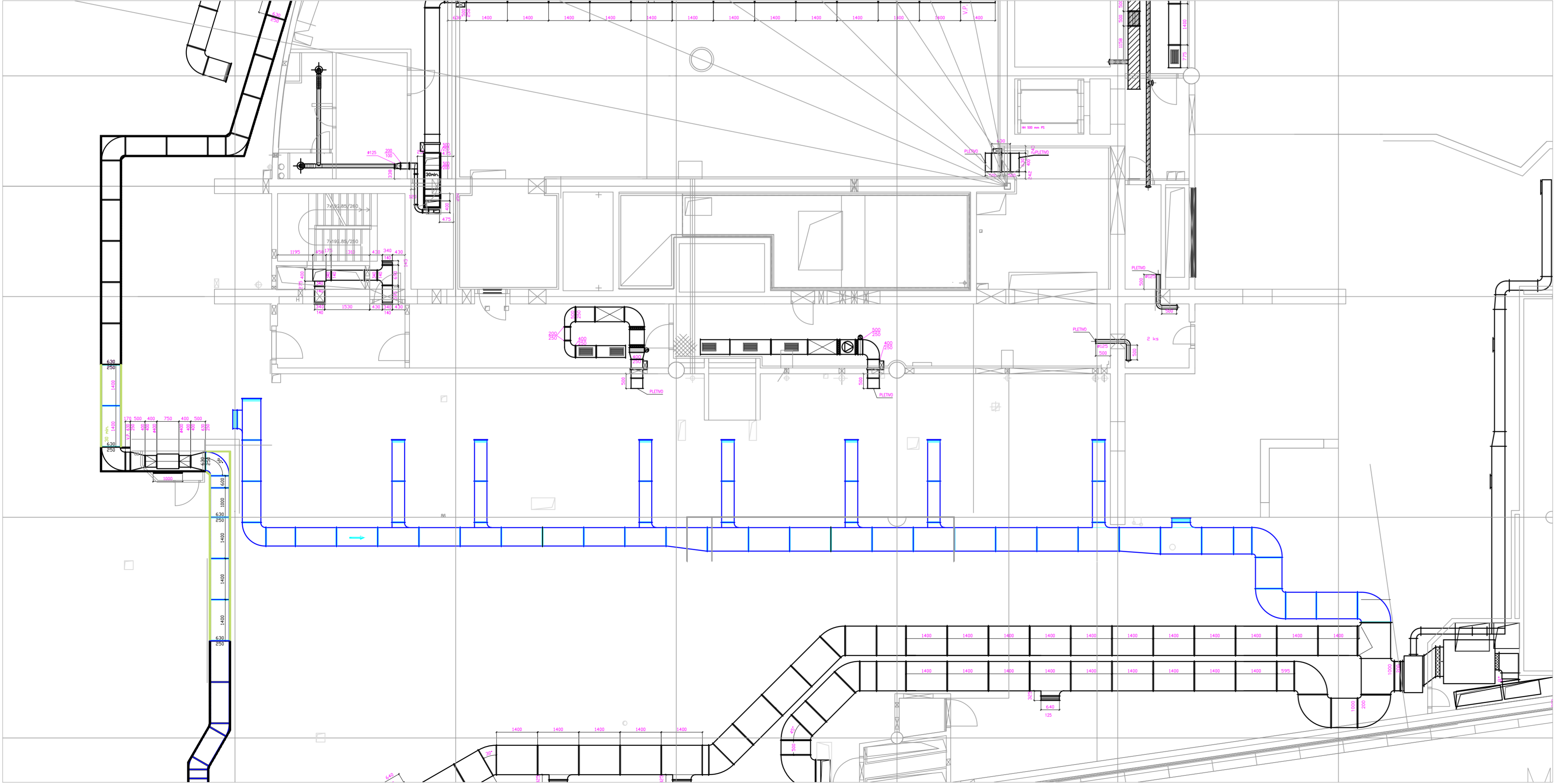
SPÄTNÁ MONTÁŽ VZT ROZVODOV PO DOKONČENÍ STAVEBNÝCH ÚPRAV
